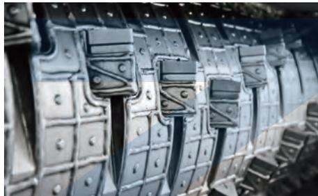
Die Rotoren der ZTS-/ZTTS-Baureihe verfügen mit 760 mm über einen sehr groß dimensionierten Durchmesser. Ihre Oberflächen sind mit einer aufgeschweißten Hardox-Schutzpanzerung versehen. Die Messer werden in Rotortaschen geschraubten Messerträgern gehalten.
