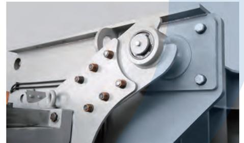
Das überdimensionierte Getriebe wird über eine äußerst robuste Drehmomentstütze gehalten, die es gegen starke Schläge während des Mahlvorganges schützt.
