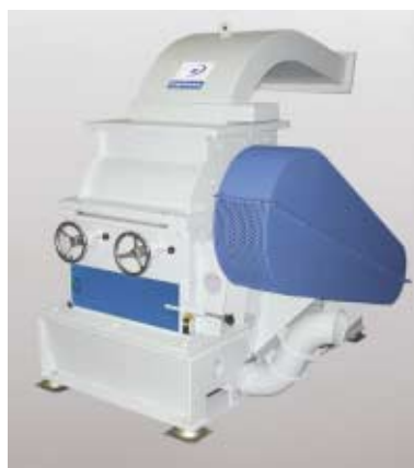
Modèle GS avec buse d'aspiration pour l'introduction de laizes latérales
