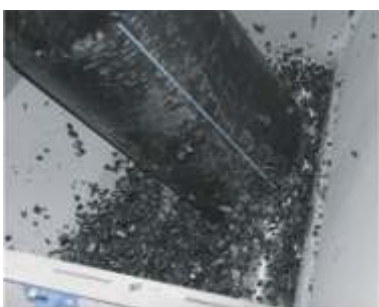
Los tubos, tras ser pre-triturados por la trituradora, se meterán en un granulador para seguir siendo procesados.
