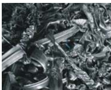
Los tubos, tras ser pre-triturados por la trituradora, se meterán en un granulador para seguir siendo procesados.
